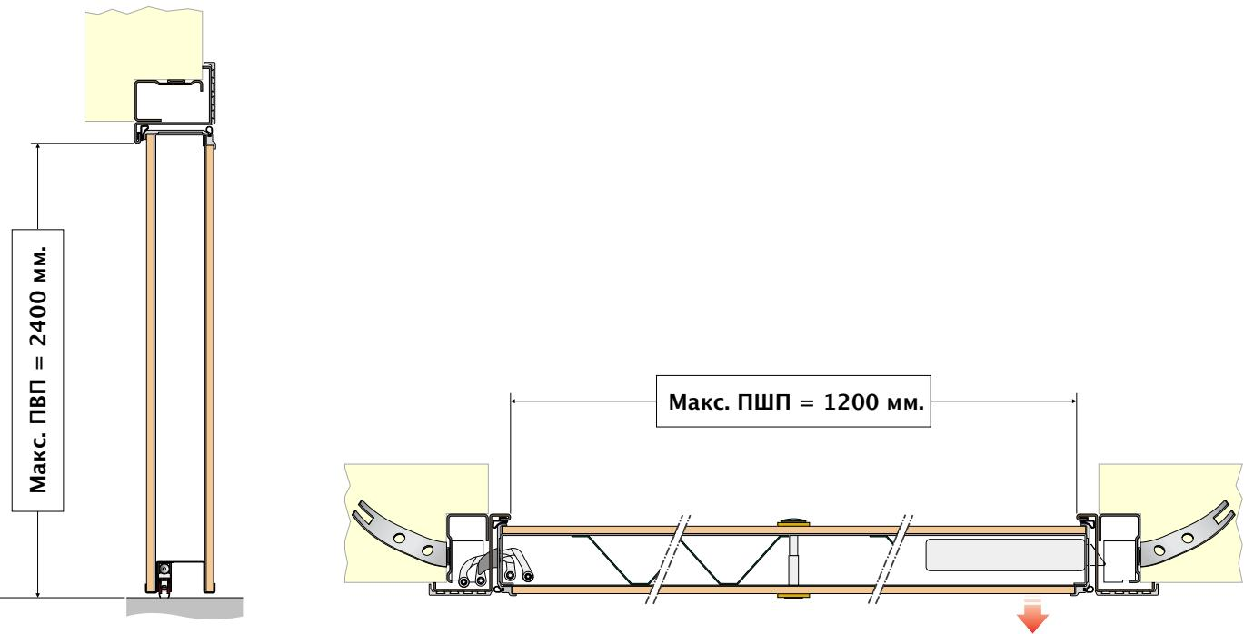
Wall Security подходит для дверных проёмов больших размеров благодаря особенностям структуры и мощным петлям. Можно установить двери с ПВП макс. 2400 мм. и ПШП макс. 2400 мм. при только двух петлях.
