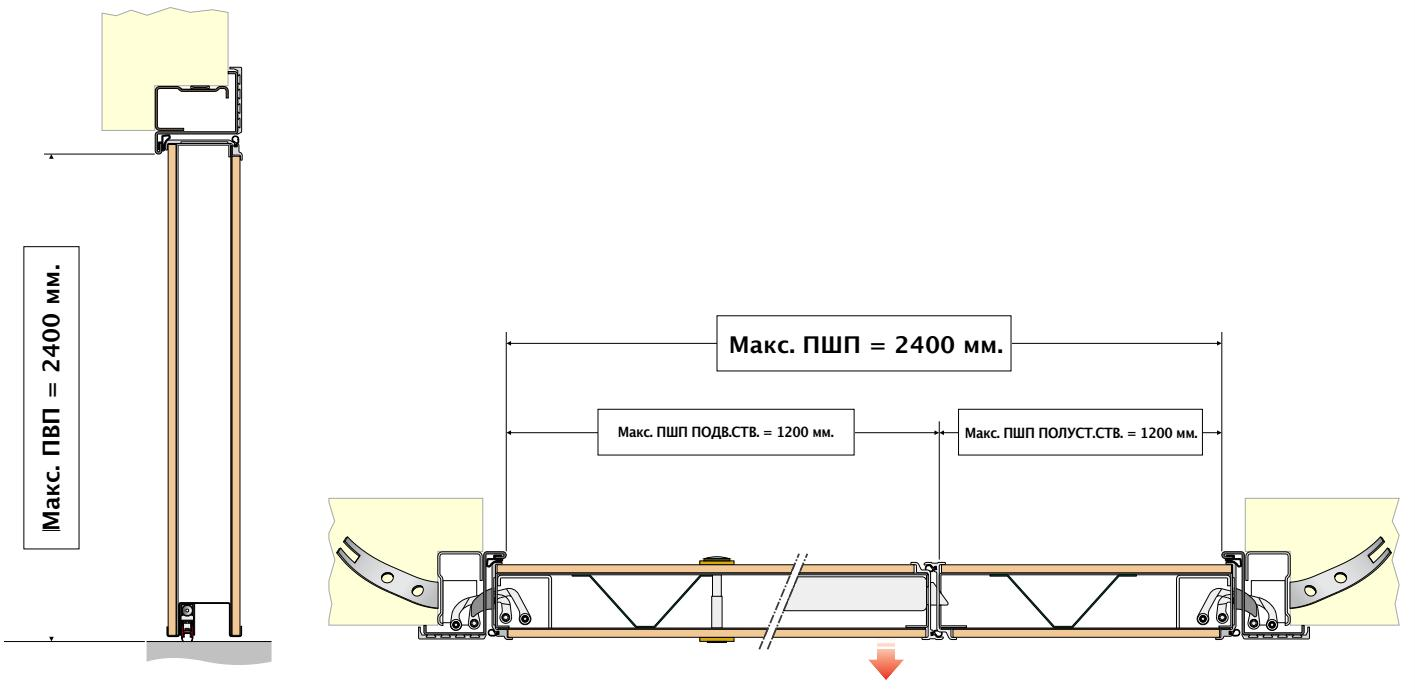
Wall Security подходит для дверных проёмов больших размеров благодаря особенностям структуры и мощным петлям. Возможно создание дверей с ПВП макс. 2400 мм. и ПШП макс. 2400 мм. всего с 4 петлями.
